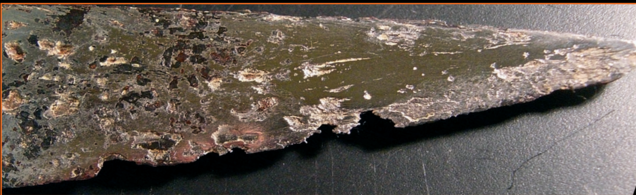
↑ Abb. oben: Zahnung Bauernwehr. Der Rost lässt die Klinge einwandfrei erscheinen, entfernt man ihn, erscheint der wahre Zustand. Herkunft und Alter unbekannt, vermutlich Bauernwehr, offensichtlicher Bodenfund. Gute Stahlqualität mit einer schlechten Härtung, Kohlenstoffunterschiede sind im Stahl keine vorhanden, lediglich die dem Raffinerstahl typischen weissen Linien sind zu sehen.
