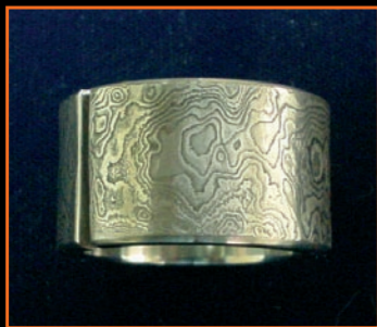
↑ Abb. oben: Ring aus rostfreiem Damaszenerstahl. Bei Schmuck ist die Resistenz gegenüber Schweiß sehr wichtig. Ein weiteres Problem ist der Nickel im Metall, welcher Allergien auslösen kann. Daneben Vergrößerungen.
