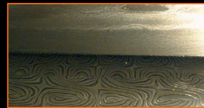
↑ Abb. oben: Omas altes Besteckmesser. Solche Gebrauchsgegenstände sind an jedem Flohmarkt für ein paar Euros zu haben. Mitte: Vergrößerung 6,3X. Rechte Seite des Stempels. Gut zu sehen sind die feinen weissen Begrenzungslinien welche Raffinierstahl kennzeichnen. Rechts: Vergrößerung 25X. Der Blickwinkel zeigt die auspolierten weissen Linien und Poren. Die Grösse des Einschlusses macht den Schmiedefehler aus.
