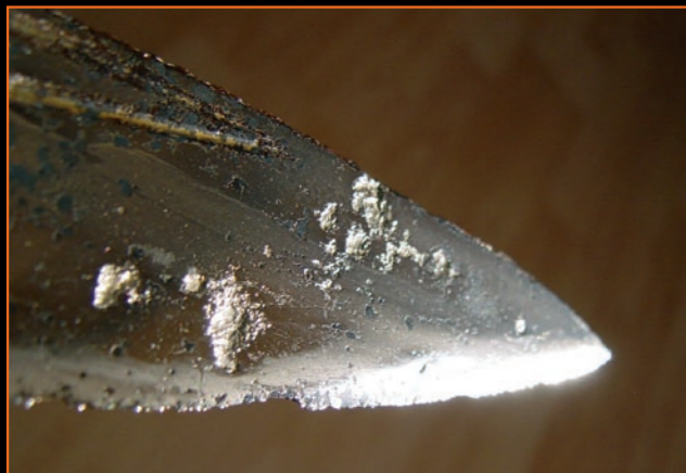
↑ Abb.: Saxklinge, vermutlich 800 n. Chr. Das grobe Zusammenschmieden von differenziert hergestellten Raffinierstählen machen die Strukturen in der fertigen Klinge unberechenbar. Nicht nur, dass der Kohlenstoffgehalt in den Zonen unterschiedlich ist, auch die „weissen Linien“ können mehr oder weniger stark erscheinen.
