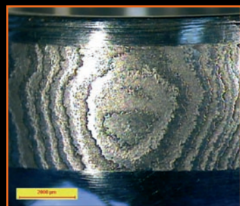
↑ Abb. oben: Ring aus rostfreiem Damaszenerstahl. Bei Schmuck ist die Resistenz gegenüber Schweiß sehr wichtig. Ein weiteres Problem ist der Nickel im Metall, welcher Allergien auslösen kann. Daneben Vergrößerungen.
