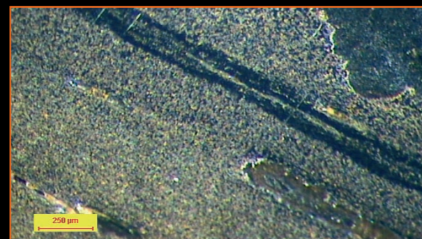
↑ Abb.: Saxklinge, vermutlich 800 n. Chr. Vergrößerung. Solche kohlenstoffreiche Lagen sind eher ein Missgeschick als gewollt.
