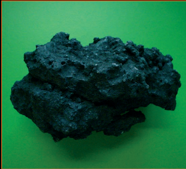
↑ Abb. links: Luppe aus Europa. ↗ Abb. rechts: Eisen kommt nicht in reiner Form in unserer Natur vor. Es ist ein Gemisch aus verschiedenen Stoffen. Das Aussehen von Erz ist sehr unterschiedlich, es kann Sand sein Kugeln oder Gesteinsbrocken. Die Farbe ist auch sehr unterschiedlich, nur selten könnte man in dem Gestein Eisen vermuten.
