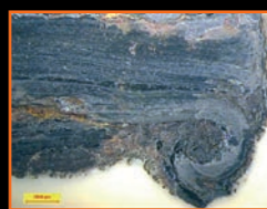
↑ Abb. oben: Eisennagel, gefunden in der Nähe einer Burg. Das Alter kann nicht bestimmt werden, vermutlich ist er einige Jahrhunderte alt. Verbrauchsmaterialien wie Nägel, Beschläge oder Holzklammern wurden meist nicht gehärtet, entsprechend musste man nicht auf die Härbarkeit achten. Der Kopf des Nagels weist nur noch einen Teil der ehemaligen Substanz auf. Der Rost ist stark gewachsen und hat den Stahl mit einer dicken Hülle umgeben. Die Kohlenstoffunterschiede und der Phasenverlauf sind gut sichtbar, einfache Eisenwaren wurden sorglos hergestellt, sicherlich wurden viele wertvolle Eisenreste wiederverwertet. Unten: Die Kohlenstoffkonzentrationen im Stahl wurden nicht □
